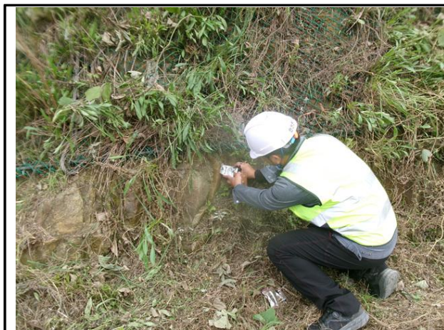
절리면 경사/경사방향 측정
